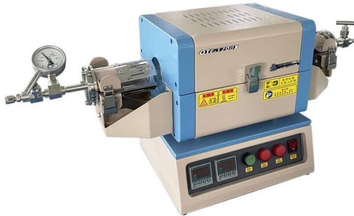
OTF-1200X-S-II 是一款通过 CE 认证的小型双温区开启式管式炉，其最高工作温度可达 1200℃，此款管式炉的炉管为高纯石英管，其直径为 25mm 或 50mm。配有一套不锈钢密封法兰。可对样品在真空状态或气氛保护状态下进行热处理。管式炉拥有两个加热长度为 100mm 的加热区，两个温区的最大恒温梯度为 200℃，若两个温区设置同样的温度程序，可得到 100mm 恒温区。两个温控系统分别独立控制两个温区，都可设置 30 段升温程序，控温精度为 ±1℃
