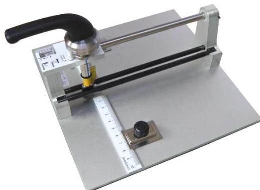
SYJ-DS100 是一款小型的手动划片机，金刚石刀头可用于划切单晶片，如硅片、蓝宝石等。划切压力通过一个弹簧来调节，最大可划切的样品长度为 100mm。
