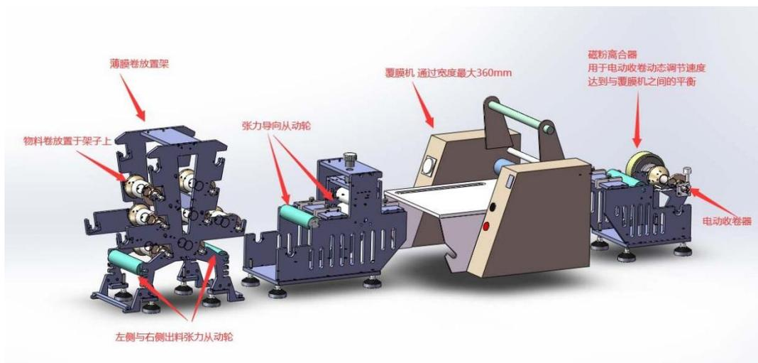
MLLR-7-12 是一款定制的七层卷对卷覆膜装置，所覆薄膜最大宽度为 12"，覆膜机最高加热温度可达 130℃，用于将 7 层薄膜层压成一层，用于电池或电池回收研究。本机可在氩气环境下工作，适用于对氧气敏感性物料。
